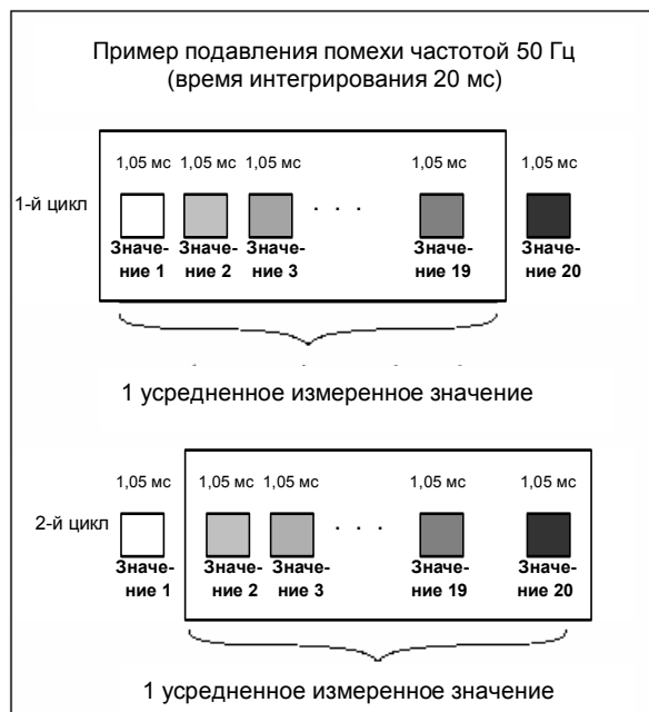
Рис. 7-5. Подавление помехи частотой 50 Гц
